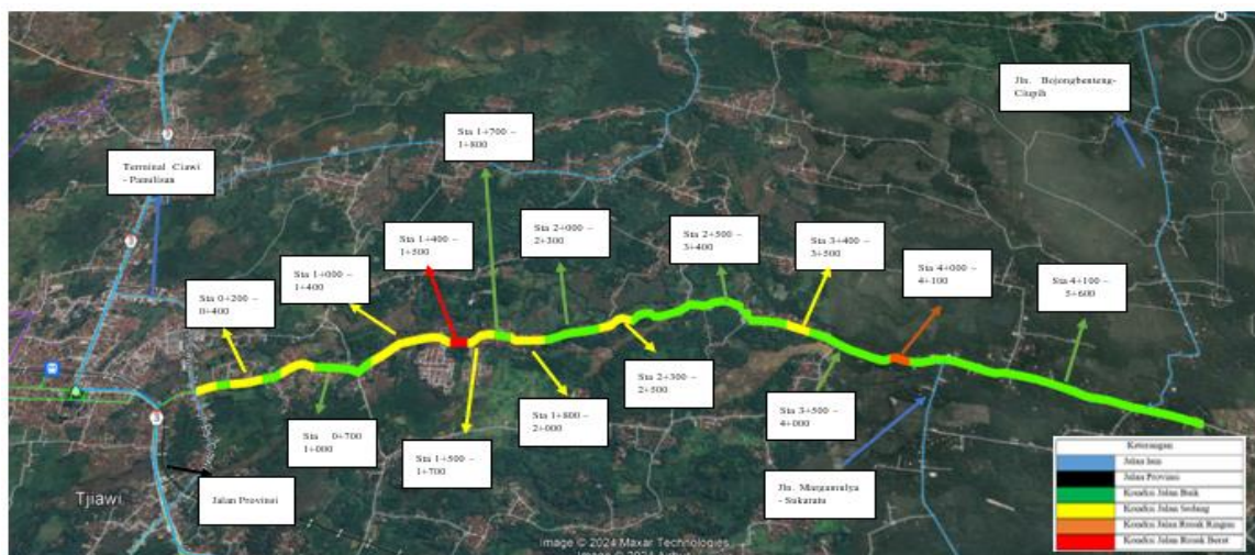
Gambar 15. Peta Kerusakan Jalan Ciawi – Panumbangan
