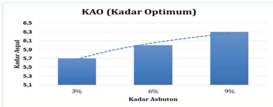
Gambar 2 Kadar aspal Optimum Untuk Masing-Masing Campuran AC-WC dengan Kadar Asbuton Butir Tipe 50/30: 3%, 6%, dan 9%
