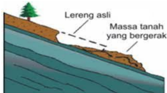
Gambar 2. Tipe Longsoran Translasi Sumber: Dokumen Pribadi
