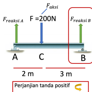
Gambar 4. Diagram Benda Bebas Pembebanan Terpusat Pada I-Beam Pada Titik A dengan Pusat Momen di Titik B
