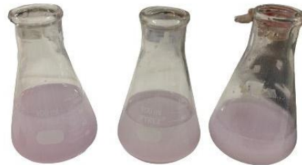
Gambar 2. Titrasi penentuan kadar kalsium dalam sampel cangkang telur ayam ras
